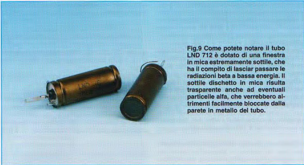
**Fig.9** Come potete notare il tubo LND 712 è dotato di una finestra in mica estremamente sottile, che ha il compito di lasciar passare le radiazioni beta a bassa energia. Il sottile dischetto in mica risulta trasparente anche ad eventuali particelle alfa, che verrebbero altrimenti facilmente bloccate dalla parete in metallo del tubo.
