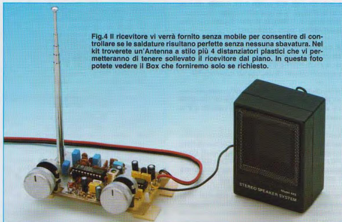
**Fig.4** Il ricevitore vi verrà fornito senza mobile per consentire di controllare se le saldature risultano perfette senza nessuna sbavatura. Nel kit troverete un'Antenna a stilo più 4 distanziatori plastici che vi permetteranno di tenere sollevato il ricevitore dal piano. In questa foto potete vedere il Box che forniremo solo se richiesto.
