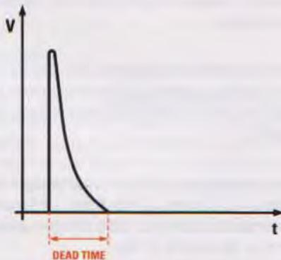
**Fig.6** Per un certo periodo di tempo, denominato **dead time**, ovvero tempo morto, il tubo risulta insensibile al transito di altre particelle o fotoni, che non vengono rilevati. Di questo fenomeno, che diventa significativo solo a valori molto alti di radioattività, tiene opportunamente conto una correzione statistica inserita nel software del contatore.
