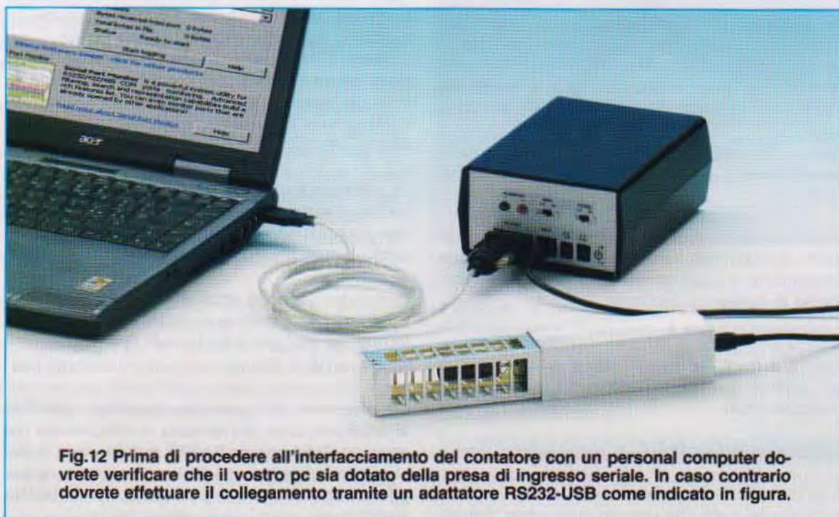
**Fig.12** Prima di procedere all'interfacciamento del contatore con un personal computer dovrete verificare che il vostro pc sia dotato della presa di ingresso seriale. In caso contrario dovrete effettuare il collegamento tramite un adattatore RS232-USB come indicato in figura.
