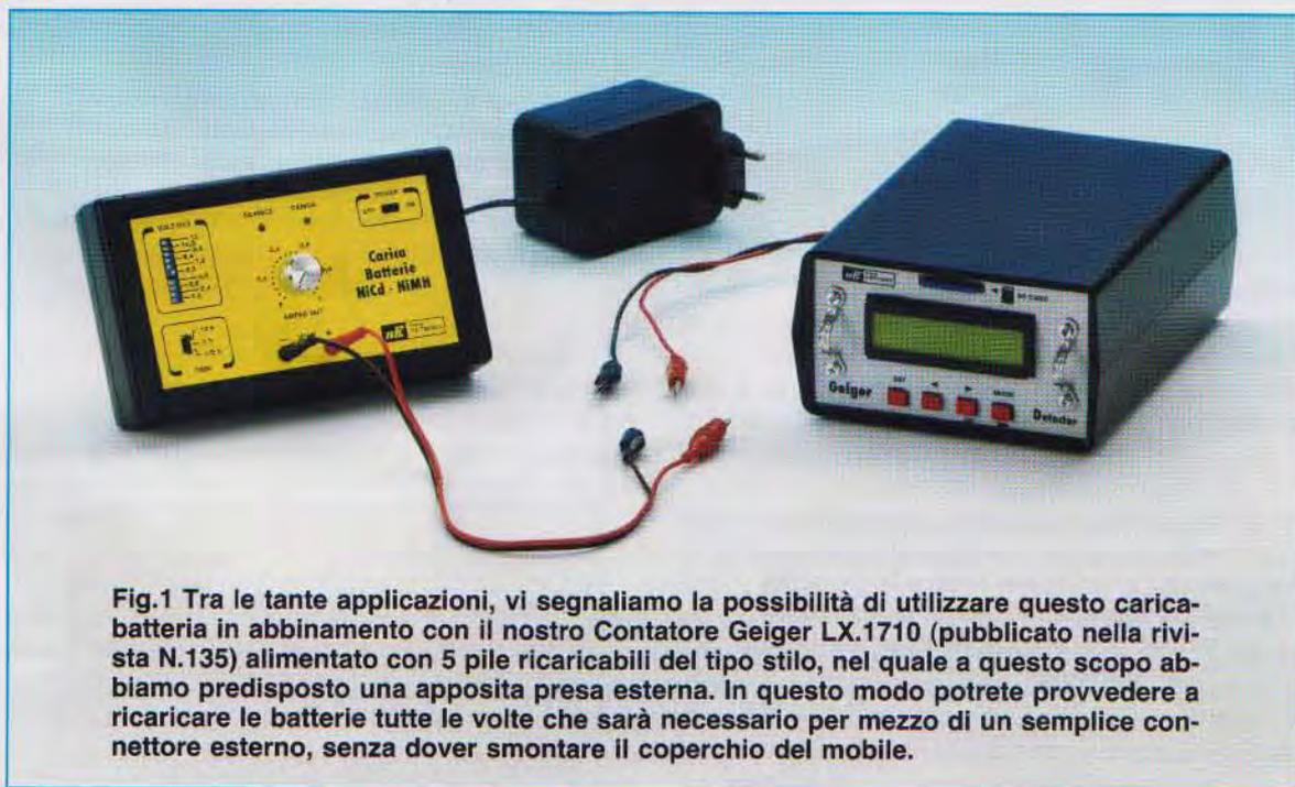
Fig.1 Tra le tante applicazioni, vi segnaliamo la possibilità di utilizzare questo carica-batteria in abbinamento con il nostro Contatore Geiger LX.1710 (pubblicato nella rivista N.135) alimentato con 5 pile ricaricabili del tipo stilo, nel quale a questo scopo abbiamo predisposto una apposita presa esterna. In questo modo potrete provvedere a ricaricare le batterie tutte le volte che sarà necessario per mezzo di un semplice connettore esterno, senza dover smontare il coperchio del mobile.
