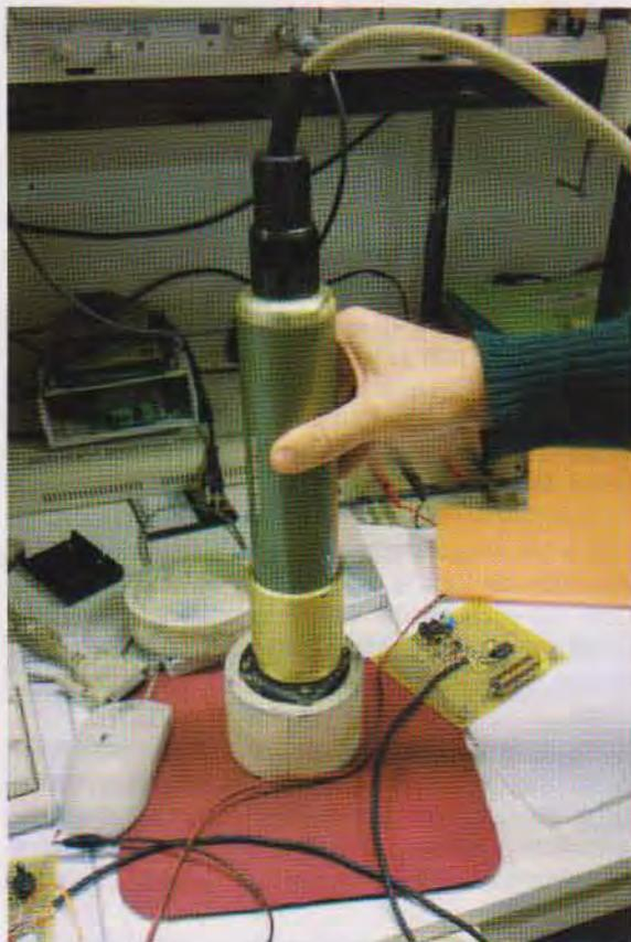
**Fig.11** Il nostro contatore Geiger prevede la possibilità di collegare un terzo tubo a piacere, con tensione di alimentazione compresa tra 400 e 500 Volt, oltre al tubo LND 712 e SBM 20 già previsti.
