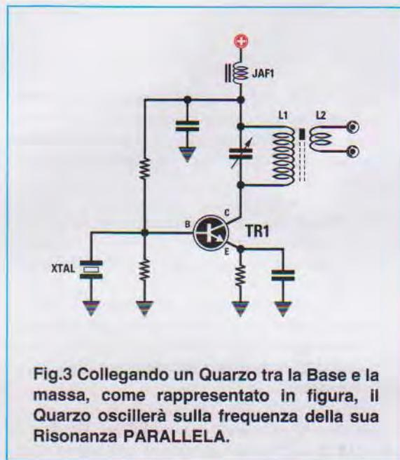
Fig.3 Collegando un Quarzo tra la Base e la massa, come rappresentato in figura, il Quarzo oscillerà sulla frequenza della sua Risonanza PARALLELA.
